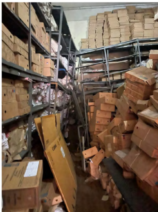
Abbildung 3: Zu schwache und überladene Regale im Archivraum der ORKB von Madagaskar
